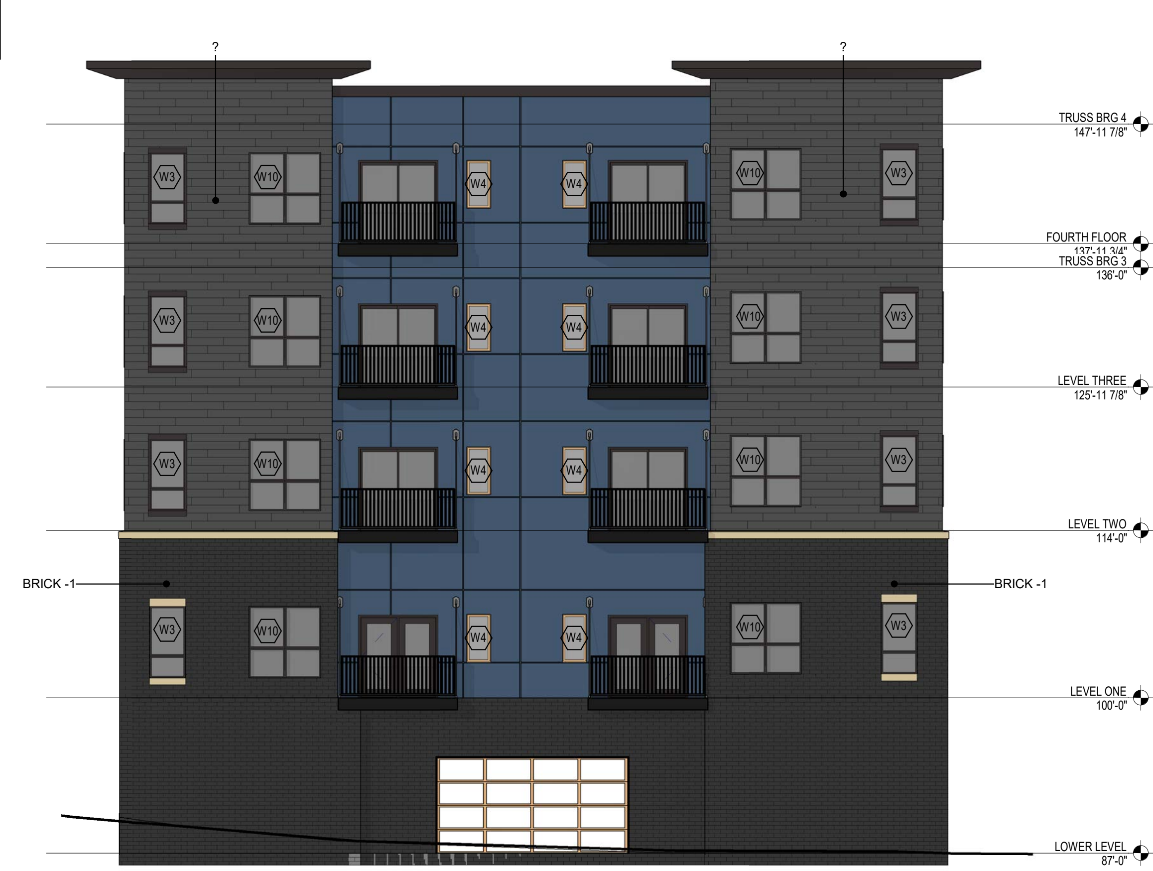
3 A3.5 AREA F - IL NORTH ELEVATION 1/8" = 1'-0"
